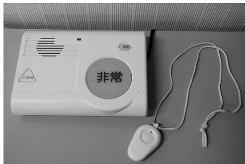
緊急通報装置
